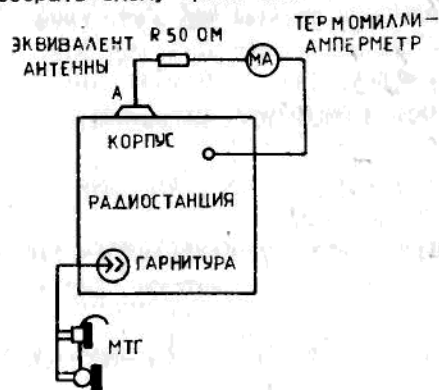
Рис. 13. Схема измерения тока в эквиваленте антенны
