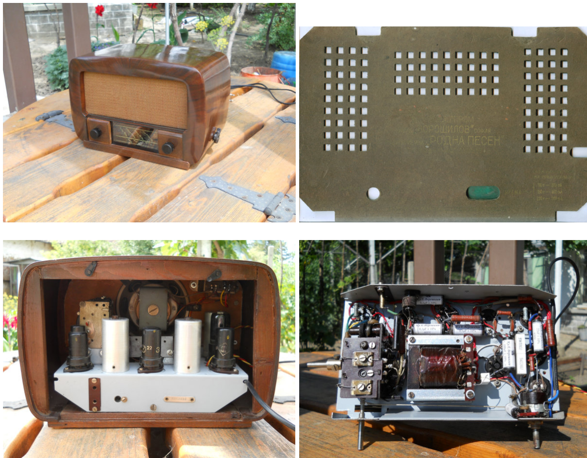
Фиг.1. Радиоприемник „Родна песен” Р-III-54-4 (6А7, 6К3, 6Г2, 6П6С, 6Ц5С) №0054469
